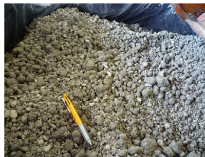
幌延の掘削スリを用いた埋め戻し材の例
